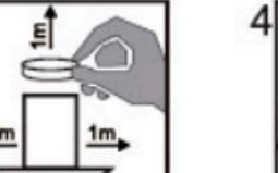
Agite el tubo y después retire la tapa y coloque el tubo sobre una superficie que pueda recibir calor, alejada de objetos en un radio y altura de 1 metro.
